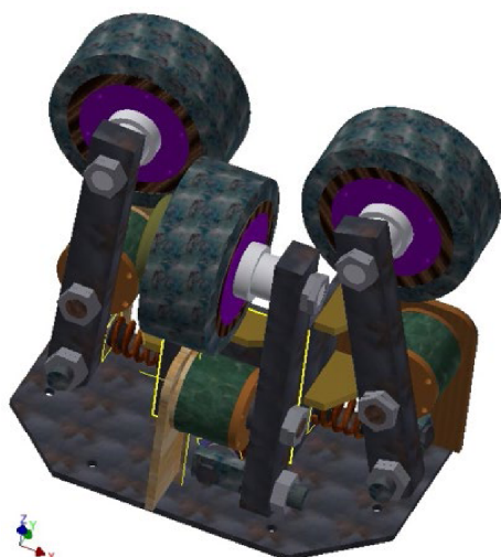
Фигура 5.3. 3 D модел на триролков блок за скип
