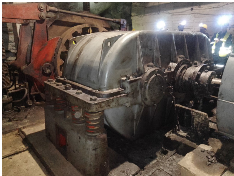
Фигура 1.6. Многовъжена подъемна уредба тип МК 2,1 х4Р- 18 работеща на шахта „Петровица“ – в „Горубсо“-гр. Мадан
