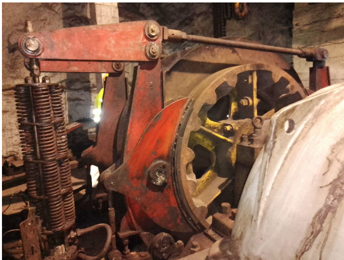
Фигура 1.15. Спирачна система за многовъжена подъемна уредба тип МК 2,1 х4Р- 18 работеща на шахта „Петровица“ – в „Горубсо“-гр. Мадан
