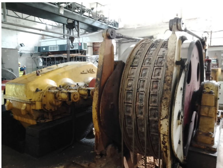
Фигура 1.5. Многовъжена подъемна уредба тип МК 2,25 х4Р-6 работеща на шахта „Крушев дол“ – в „Горубсо“-гр. Мадан
