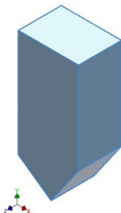
Фигура 5.4. 3 D модел на насипния материал в скипа
