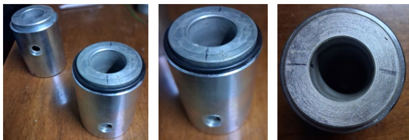
Фиг. 5.4. Еластични тела на силомери след механична обработка и поцинковане: общ вид с предпазен метален капак (вляво), тяло с уплътнителен пръстен (в средата) и маркирани места за залепване на тензодатчиците съгласно измервателната схема (вдясно) (оригинална снимка на автора)
