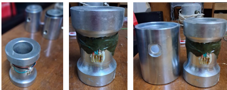
Фиг. 5.6. Влагозащита на залепените тензодатчици и предпазен капак на силомера: измервателно тяло със залепени датчици и изведени проводници (вляво), тяло с нанесена пастообразна изолация (в средата) и предпазен метален капак преди монтирането му (вдясно) (оригинална снимка на автора)
