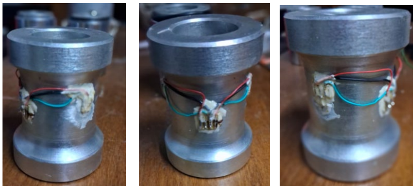
Фиг. 5.5. Еластично тяло на силомер със залепени фолийни тензодатчици и свързани изводни проводници след процедурата на притискане с двукомпонентното лепило X60 – три изгледа (оригинална снимка на автора)
