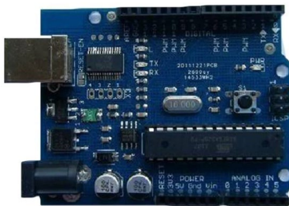
Фиг. 10. Основни елементи на развойната платка Arduino Uno
