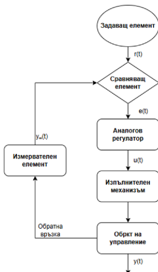
Фиг. 3. Структурна схема на аналогова система за автоматично управление с отрицателна обратна връзка
