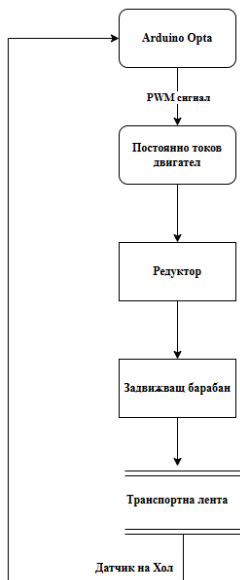
Фиг. 36. Функционална структура на задвижващия механизъм
