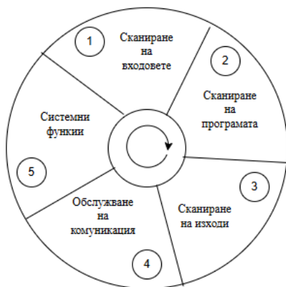
Фиг. 5. Оперативен цикъл на програмируем логически контролер (PLC)
