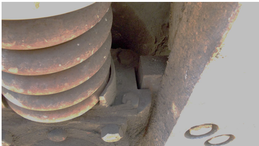
Фигура 4-7. Монолитен буксов възел 4 години експлоатация
