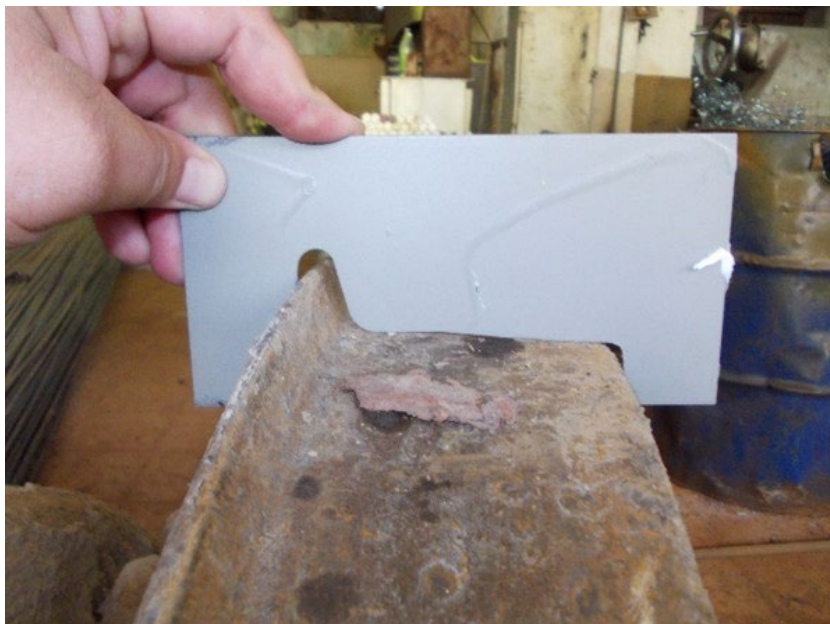
Фигура 3-2. Износване на реборда, рудник „Петровица“
