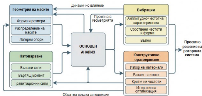
Фиг. 4. Обобщена схема на взаимовръзката между геометрия, натоварване, вибрации и конструктивно оразмеряване в роторни системи
