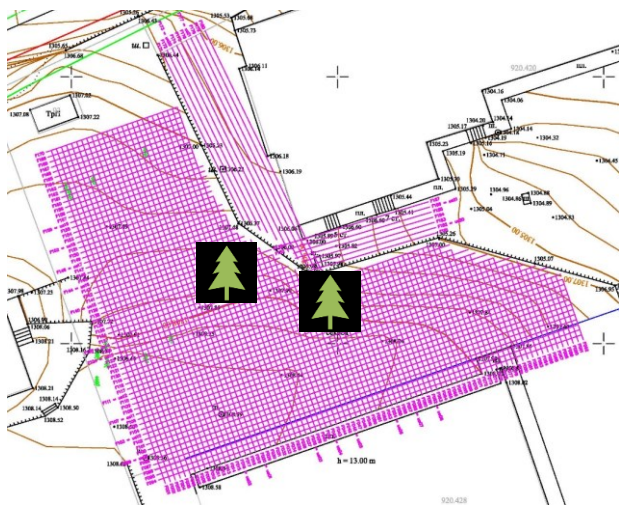
Фиг. 3. Схема на георадарните профили около двете секвои
