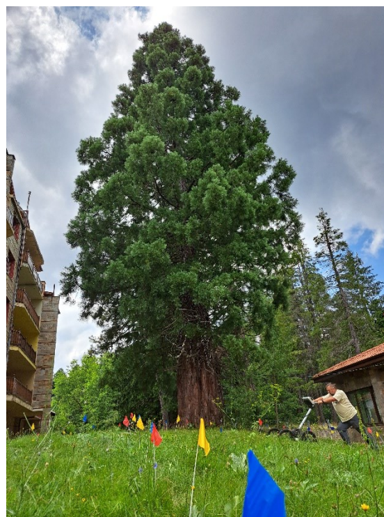
Фиг. 2. Момент от георадарните измервания с MALÅ X3M в източния участък от площта
