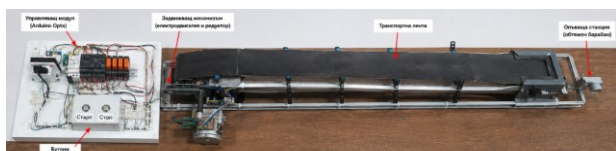
Фиг. 1. Лабораторен модел на гумено-транспортна лента и основни функционални възли
