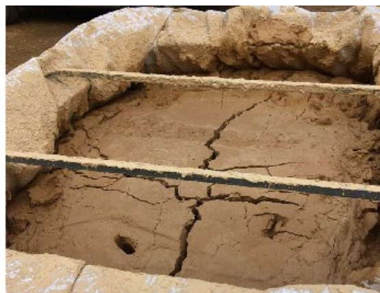
Фиг. 5. Полеви експеримент: състояние на модифицирания материал в опитна клетка на 28-ия ден
