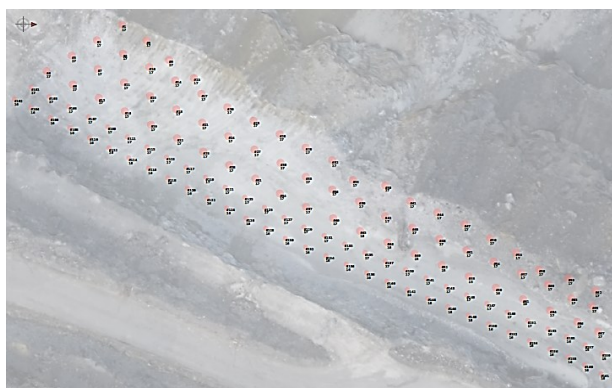
Фиг. 4. „Paradigm“ - План при проектиране на сондажно-взривна схема, изпълнена в шахматна конфигурация. Вариант №1 за ПВР
