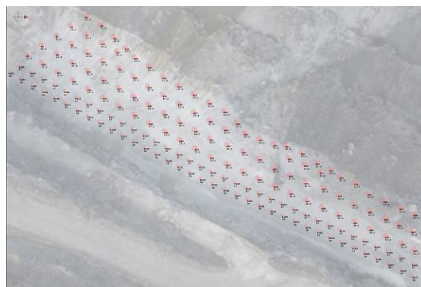
Фиг. 9. „Paradigm“- План при проектиране на сондажно-взривна схема, изпълнена в шахматна конфигурация. Вариант №2 за ПВР
