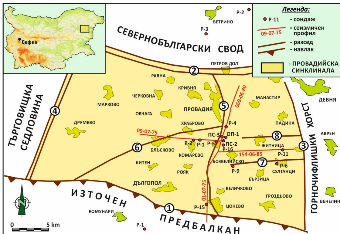
Фиг. 1. Комбинирана обзорна и тектонска схема на изследвания район с местоположение на използваните сондажи и сеизмични профили. Разломите са означени с цифри в кръгчета: 1. Преславско-Шкорпиловски; 2. Южномизийски; 3. Кубратско-Ветрински; 4. Друмевски; 5. Провадийски; 6. Храбровски; 7. Султански; 8. Падински.
