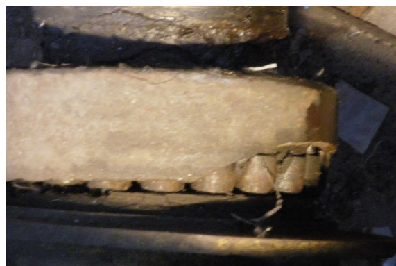
Фиг. 2. Счупен носещ лагер
