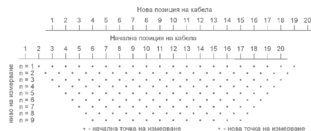
Фиг. 3. Принципна схема на стъпково преместване на кабела с примерна стъпка 2a
