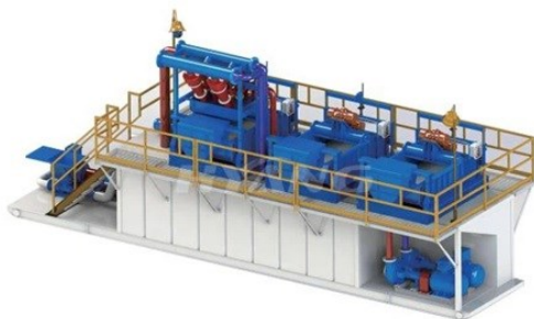
Фиг. 7. Типична система за рециклиране на промивни течности в ХНС
