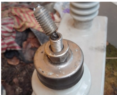
Фиг. 1. Тоководеща шпилка на кондензаторна батерия
