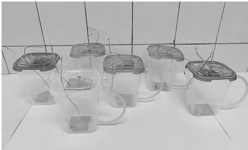
Фигура 18. Конструирани лабораторни модели СМГК-базирани биосензори
