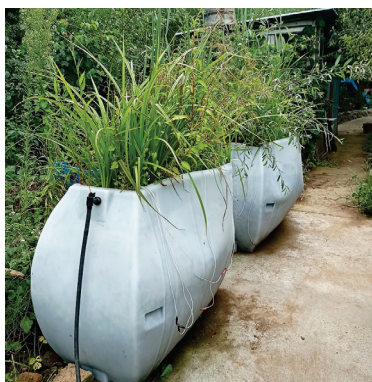
Фигура 55. Конструираната влажна зона с интегрирани седиментни микробни горивни клетки след едногодишна работа
