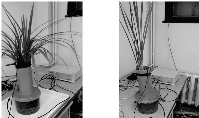
Фигура 15. Сваляне на циклични волт-амперни характериситки на седиментните микробни горивни клетки със засадена растителност
