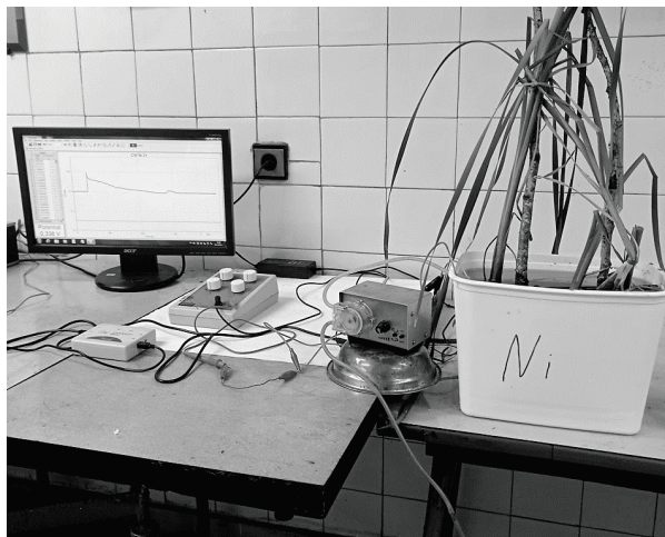
Фигура 49. Лабораторна инсталация на конструирана влажна зона с интегриран СМГК-биосензор за мониторинг в реално време и биоремедиация на води замърсени с никел
