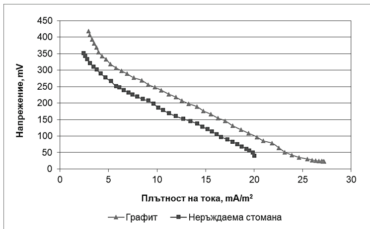
Фигура 10. Волт-амперни характеристики на СМГК-и с електроди от различен материал
