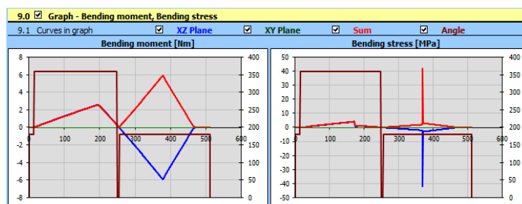
Фиг. 4.16 Графики на огъващите моменти и напреженията на огъване за изпитвания вал за втори разглеждан случай
