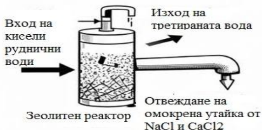
Фиг. 7.4. Вертикална зеолитна филтърна колона
