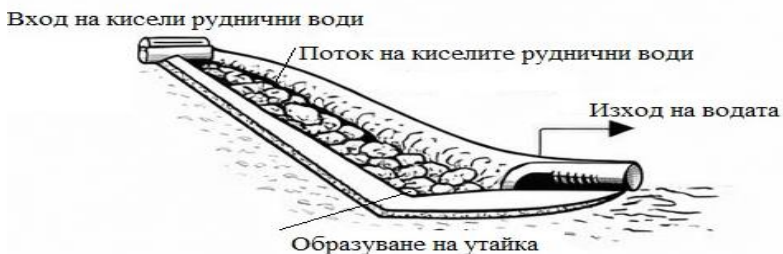
Фиг.7.2.1. Система на открити варовикови канали
