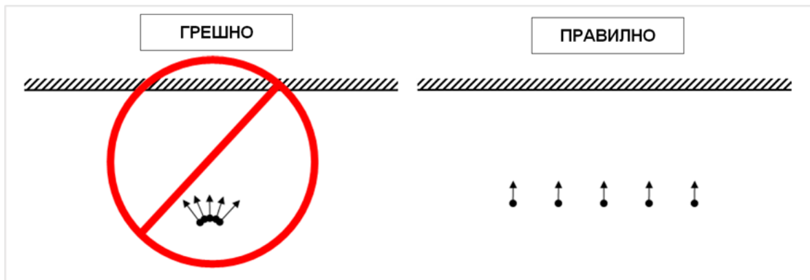
Фиг. 6.1. Разположение на камерата при заснемане на фасада
