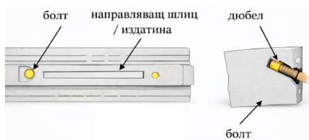
Фигура II.16 Схема на връзката между сегментите в един пръстен, [20]
