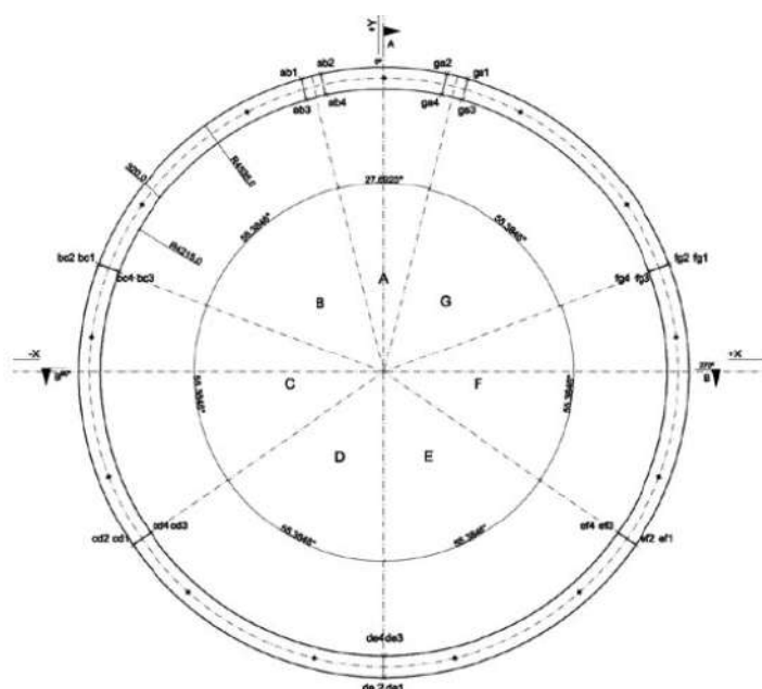
Фигура III.5 Геометрия на тунелния пръстен
