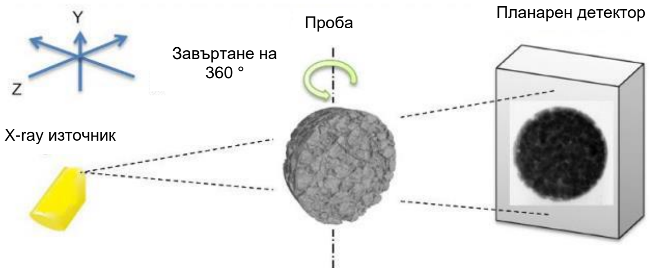
Фиг. II.20. Схема на работата на томографски апарат.
