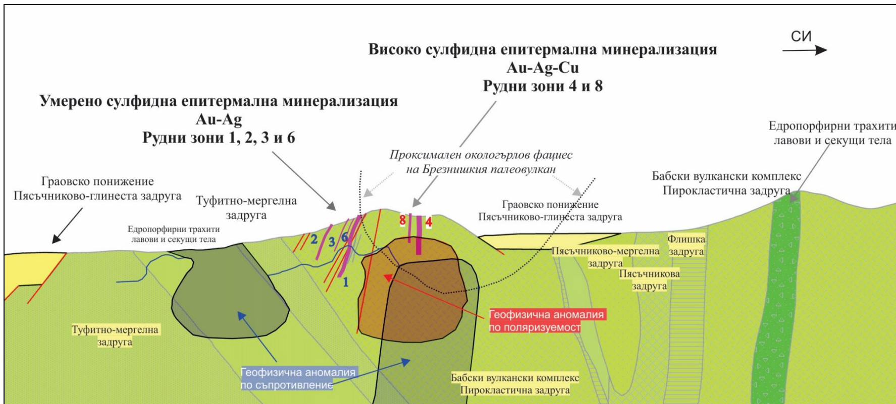
Фиг. 119. Генетичен модел на находище „Милин камък“ с наложени геофизични аномалии по съпротивление (в синьо) и предизвикана поляризация (в червено)
