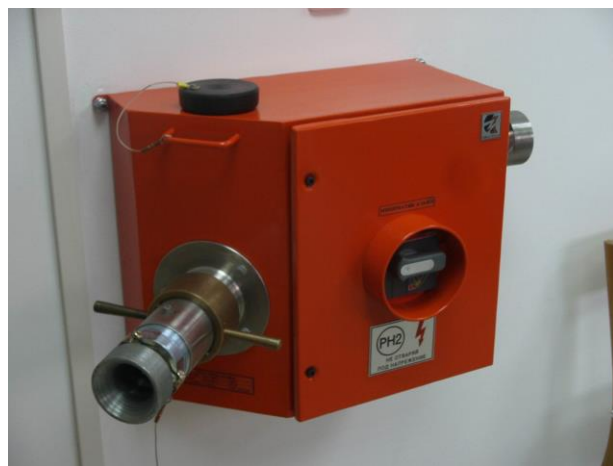
Фиг. 9. Автоматичен прекъсвач с щепселно съединение за захранване на пробивна карета.
