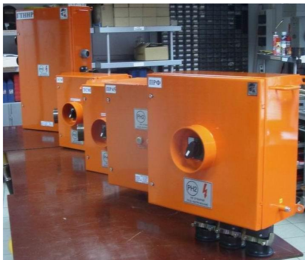
Фиг. 8. Пускатели ПР и разпределително табло ГТНН в руднично нормално изпълнение
