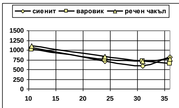
Фиг.9. Производителност [kg/h] в зависимост от периферната скорост [m/s] при три чука.
