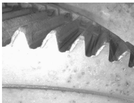
Фиг. 5. Пластично разрушаване на зъби от редуктор „РС 700М“
