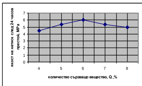
Фиг. 2. Зависимост между количеството свързващо вещество – талов пек и якостта на натиск на брикети изследвана след 24 часов престой при температура 15°C
