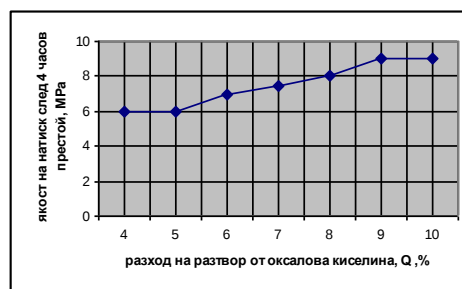
Фиг. 5. Зависимост между количеството оксаловата киселина (под формата на 10,0% воден разтвор) и якостта на натиск на брикети изследвана след 4 часов престой при температура 15°C и постоянен разход на талов пек 6,0%
