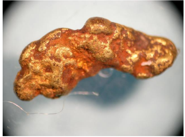
Фиг. 4. Полузагладено злато с "ямички" запълнени с хематит от р. Луда Яна; ширина 4 mm, дължина 7 mm
