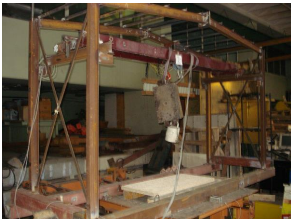
Фиг.1. Експериментален стенд- умален физичен модел на система "мостов кран-сграда"
