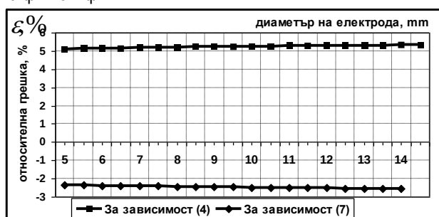
Фиг. 6. Относителна грешка в проценти на изведените зависимости за определяне съпротивлението на вертикален заземител с един концентричен слой проводящ бетон при изменение на диаметъра на електрода d
