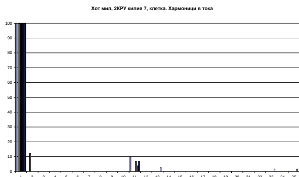
фиг.2. Хармоничен спектър в тока на стан Hot mill (12 фазна схема на изправяне)
