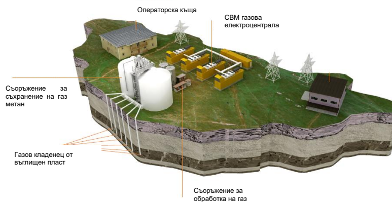
Фиг. 3.8 CBM газова електроцентрала
