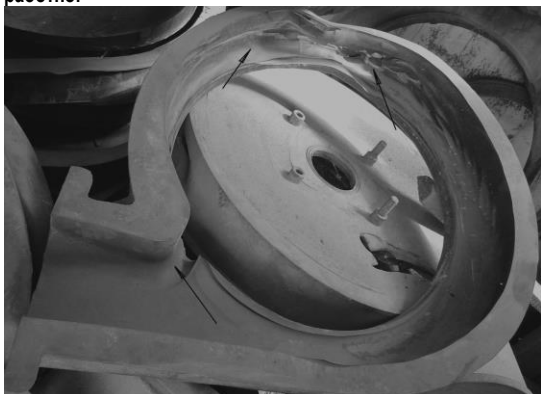
Фиг. 4. Бронирана центробежна едностъпална помпа: 1- плоча предна, 2- плоча задна, 3 – компенсатор входен (изходен), 4 – колело работно.
