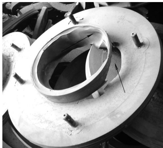
Фиг. 5. Добре изразено хидроабразивно износване на бронирано тяло (горе) и плоча предна (долу) на центробежна едностъпална помпа.
