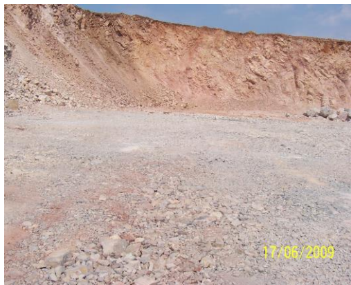
Фиг. 8. Ниво на долното стъпало от двете взривни полета
