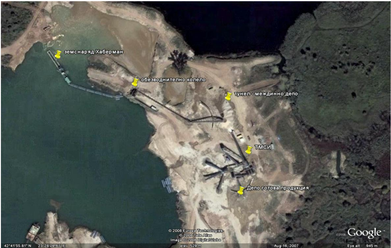
Фиг.2. Технологична схема на работа в находище „Кривина“
