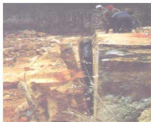
Фиг.4. Технологична схема на отделяне на блокове от скалния масив с каучукови въздушни "възглавници"
