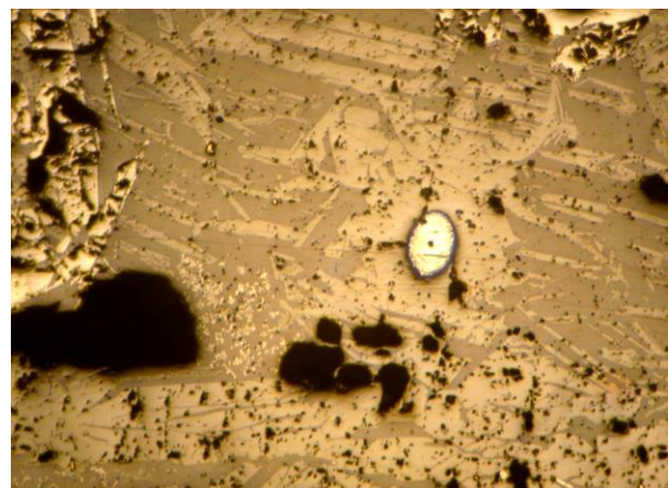
Фиг. 5. Сулфидно включение в образец от пещна шлака; отразена светлина
