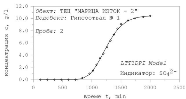
Фиг. 6. Филтрационна колонна 2. Индикатор \text{SO}_4^{2-}
