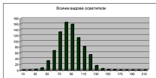
Фиг. 5. Хистограма на разпределение на светлинния добив на светодиодни осветители
