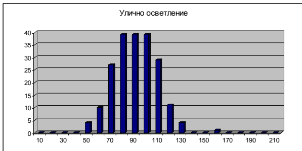
Фиг. 7. Хистограма на разпределение на светлинния добив на светодиодни улични осветители
