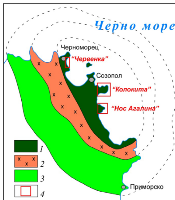
Фиг. 2. Схема за строежа на Росенския палеовулкан (по Станишева-Василева и Василев, 1981; Василев и др., 1984ф; Харковска и др., 1989) 1 – резургентна калдера; 2 – пръстеновидна интрузия (Росенски плутон); 3 – външна част (сома); 4 – местоположение на изследваните геотопи
