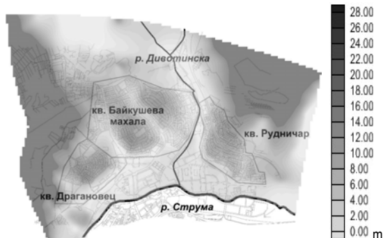
Фиг. 13. Втори прогнозен модел. Дълбочина на подземните води след края на открития възгледобив и при продължителни дъждове.
