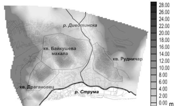
Фиг. 11. Втори прогнозен модел. Дълбочина на подземните води след спиране на открития въгледобив.
