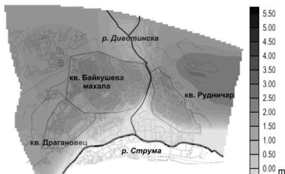
Фиг. 14. Първи прогнозен модел. Покачване на подземните води след края на открития възгледобив и при продължителни дъждове.
