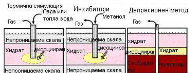
Фиг. 5. Възможни методи за добив от газохидрати (по проект на Liaoning Hi-Tech Energy Group)
