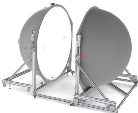
Фиг. 2. Общ изглед на кълбовия фотометър
