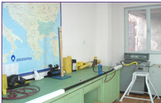
Фиг. 1б. Експериментална стенова установка за определяне хидравличната характеристика на полиетиленови тръби (Harizanov, Boyadjiev, 2007)
