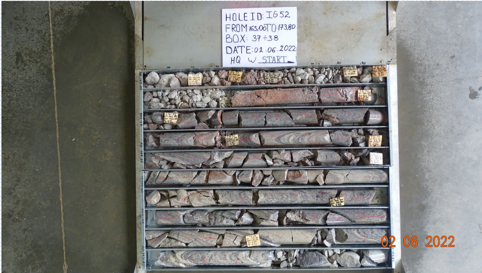
Фотография на сондажната ядка. Интервал 165.00-173.80 метър
