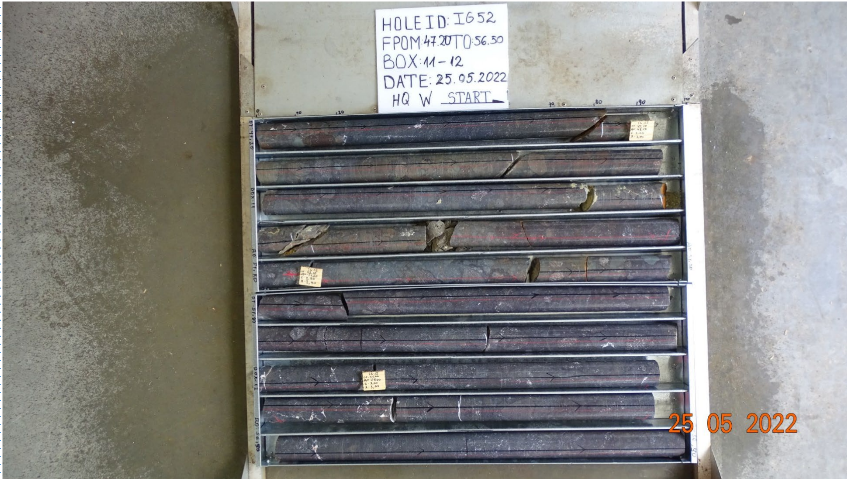
Фотография на сондажната ядка. Интервал 47.20-56.50 метър.
