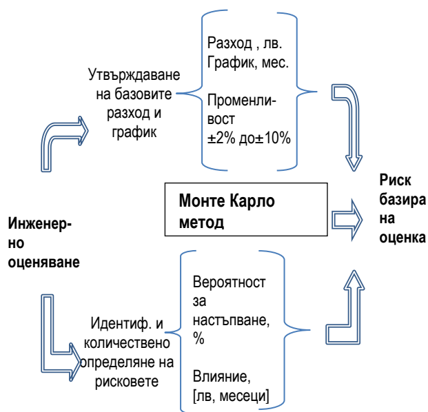
Фиг. 1. Процес на оценяване на разход и график с риск анализ на строителен проект
