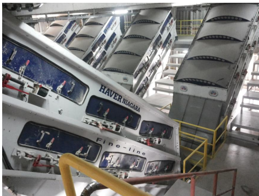
Рис. 7. Грохота тонкой класификации „HAVER-FINE-LINE HD 1850 x 3750“
