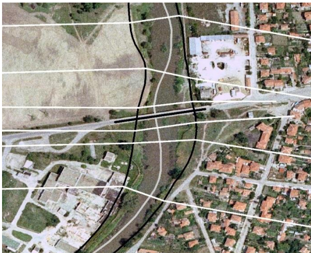
Фиг. 4. Местоположение на напречните профили през р. Тунджа и мостовото съоръжение в план
