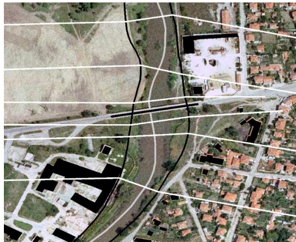
Фиг. 6. Определяне на местоположението на препятствия за водния поток (запълнените с черен цвят полигони)
