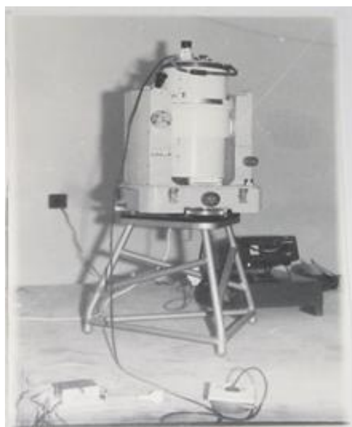
Фиг. 4. Руска установка УЕГП-1 № 95 за еталониране на гравиметри по метода на наклона
