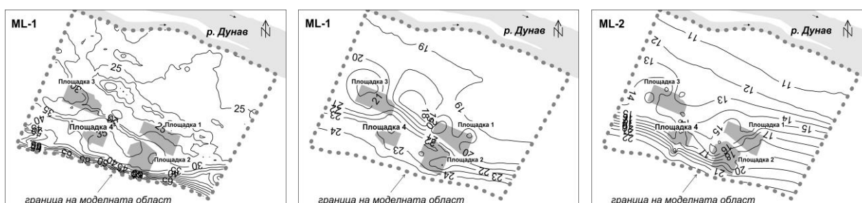
Фиг. 3. Релеф на горнището и долнището на моделен пласт ML-1 и долнището на моделен пласт ML-2
