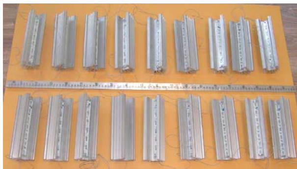
Фиг. 8. 18 броя осветители, всеки от които излъчва в тясна зона от спектъра.
