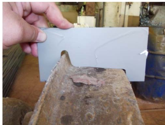
Фиг. 7. Островърхо износване на бандаж в рудник „Марзян“.
