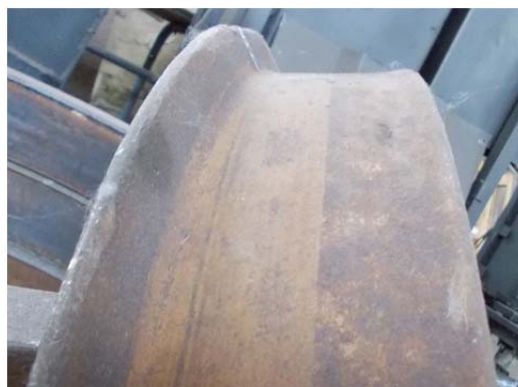
Фиг. 6. Накатяване на повърхността на реборда в мина „Бобов Дол“.
